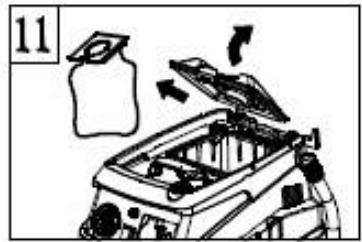
Отстегните фиксаторы и поднимите корпус
