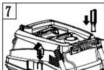
Установка шланга для использования пылесоса в качестве обдува на передней панели. Вставьте шланг и поверните для фиксации.
